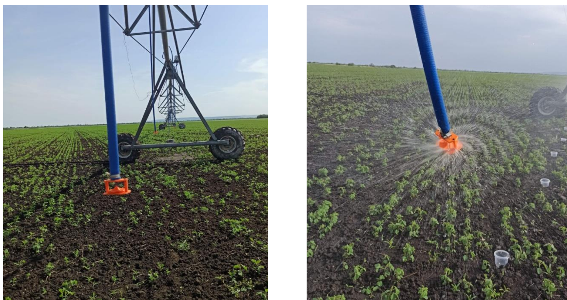
Рисунок 10 – Производственные испытания ДМ «Каскад», оснащенной предлагаемыми дождевальными насадками с оптимальными параметрами
