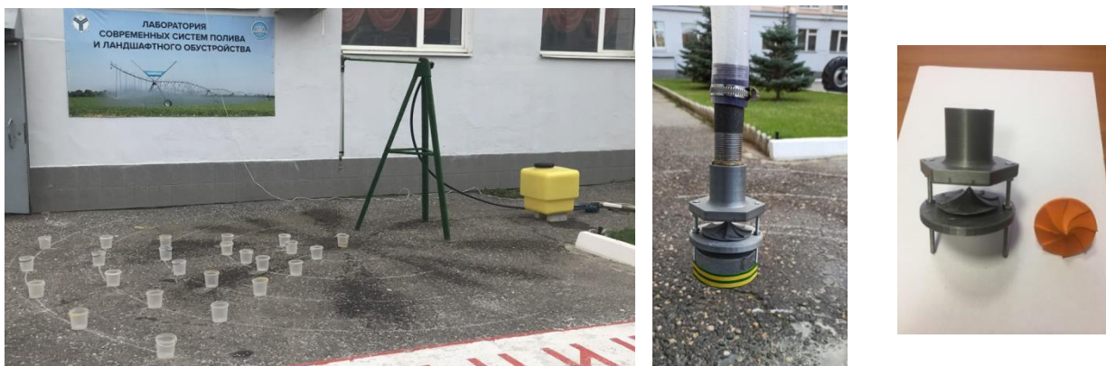
Рисунок 4 – Общий вид лабораторной установки с исследуемыми дождевальными насадками
